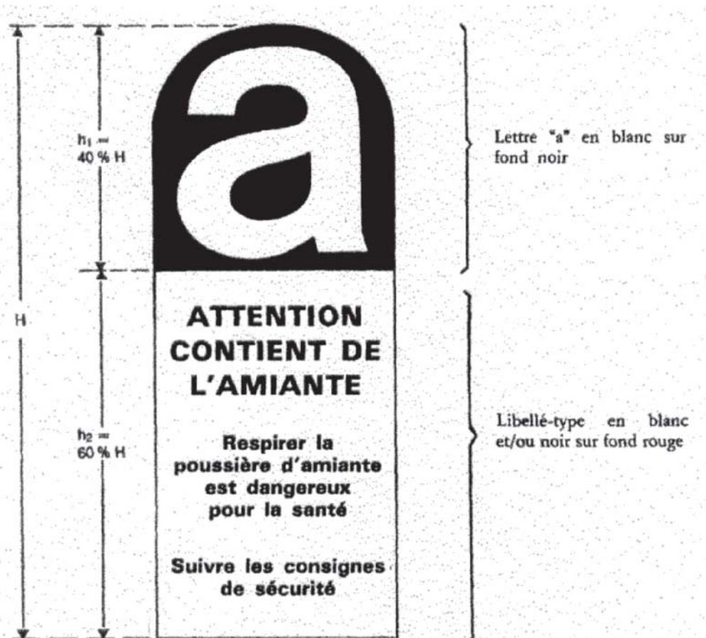
2. L'étiquette visée dans le présent appendice doit être apposée conformément aux règles suivantes:
